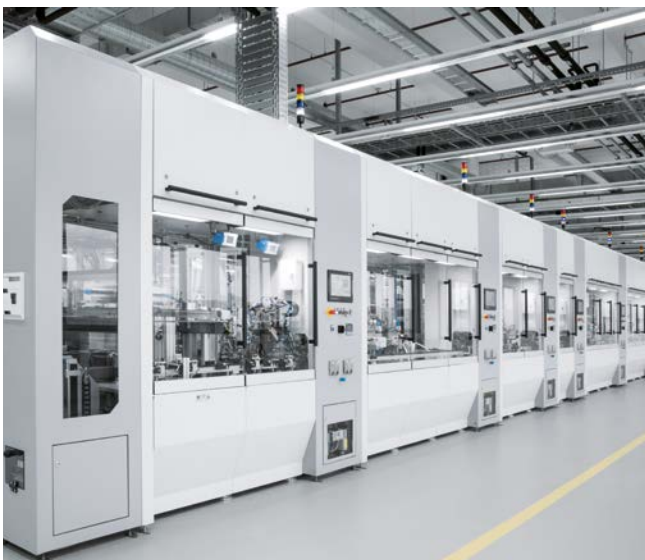
Vollautomatische Ventilmontage und die Lernfabrik im Produktionsstandort Scharnhausen von Festo
